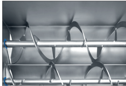
Ausführung mit Mischspirale
