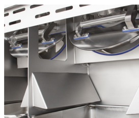
Flaps hidráulicos de descarga
