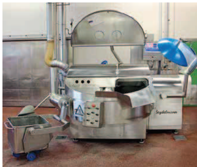
Mit einem Schüsselinhalt von 750 l bietet der K 754 ausreichende Kapazität für große Produktionsmengen.
